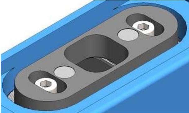
Abbildung 2: Schließblech in Aussparung
