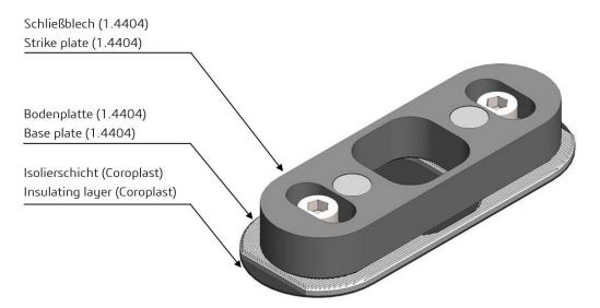
Falls die Aussparung in der Tür zu tief ist, sodass sich der Maximalabstand von 12 mm zwischen dem Schließblech und dem HD-Lock nicht einhalten lässt, kann ein Distanzplatten-Set (Art. Nr.: 102931.0) verwendet werden, um das Schließblech zu unterlegen.
