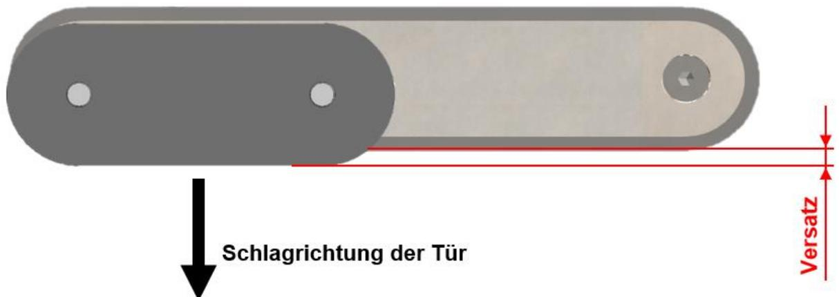
**Abbildung 2: Deckungsgleicher Abstand zwischen Verriegelungselement und Schließblech**
